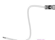
Varmepumpe 485-kabel X1
